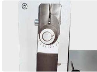
Das Modell Punch 500 ES ist mit verstellbaren Zugarmen ausgestattet. Dadurch können Standard- und Hochleistungsstanzwerkzeuge verwendet werden.
