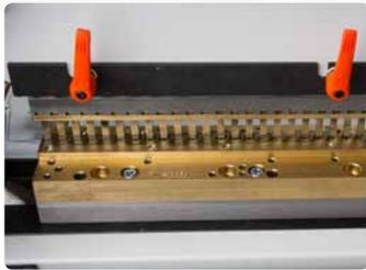
Einfacher und schneller horizontaler Werkzeugwechsel.
