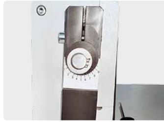
Die Punch 700 Modelle sind mit verstellbaren Zugarmen ausgestattet. Dadurch können die Hochleistungsstanzwerkzeuge mehrfach nachgeschliffen werden.
