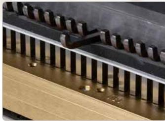
Die QSA-Technologie (Quick Size Adjustment) erlaubt das sekundschnelle Ausschalten der Stanzstempel ohne Ausbau des Werkzeugs.<sup>(1)</sup>
