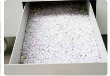
Große Abfallschublade kann zur Entleerung bequem an der Vorderseite der Maschine entnommen werden.
