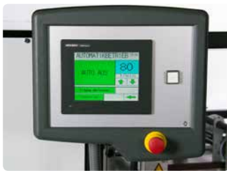
Maschineneinstellung durch Touchscreen mit 40 Job-Speicherplätzen
