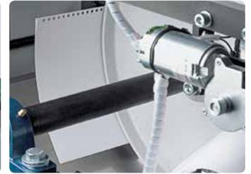
Nach dem Stanzen werden die Stanzlagen zur Einhaltung der korrekten Blattreihenfolge über eine Wendetrommel in die Auslage transportiert. Für Grammaturen von 60 bis zu 800 gr./m<sup>2</sup>.
