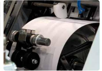
Nach dem Stanzen werden die Stanzlagen zur Einhaltung der korrekten Blattreihenfolge über eine Wendetrommel in die Auslage transportiert.
