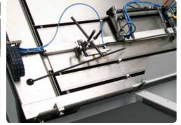
Automatisches Ansaugen der Deckblätter ab 300 gr./m<sup>2</sup>
