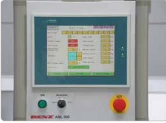
Bedienerfreundliche, mehrsprachige Touchscreen-Steuerung für schnelle und einfache Formatumstellung. Jobspeicherfunktion zur automatischen Speicherung von produktspezifischen Einstellungen optional erhältlich.
