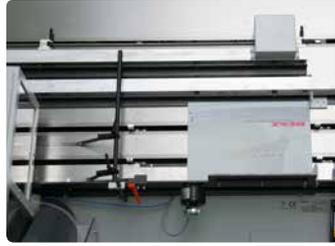
Materialeinzug wird automatisch ausgelöst. Das Transportsystem befördert das Stanzgut perfekt ausgerichtet in die Bindestation.
