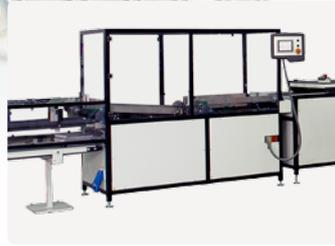
Optionale Erweiterung: Kreuzleger KL 500 - stapelt die Produkte jeweils um 180° gedreht für standsicher ausgeordnete Verpackung.
