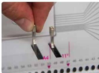
Die QSA-Technologie (Quick Size Adjustment) erlaubt das sekundschnelle Ausschalten der Stanzstempel, wodurch Papierformate einfach und schnell gewechselt werden können.
