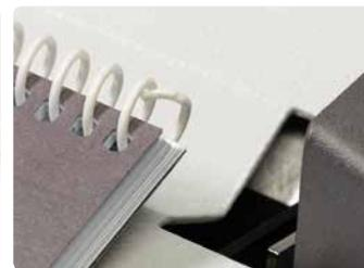
Perfektes Abschneiden und Umbiegen der Plastikspiralenden durch die integrierte Spiralabschneide- und Umbiegevorrichtung. Für Metallspiralen wird eine SC-Zange benötigt.
