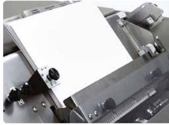
Die APSI 300 compact nutzt die Schwerkraft für ihre Zwecke. Der vorgestanzte Buchblock wird in der Maschine auf dem Buchrücken positioniert. Register oder überstehende Umschläge können somit problemlos mit eingebunden werden.
