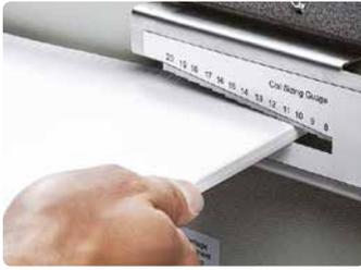
Die APSI 300 compact besitzt eine integrierte Maßskala zur Ermittlung des korrekten Spiraldurchmessers für jede Blockstärke.
