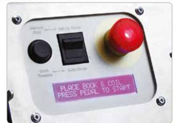
Die APSI 300 compact führt mittels eines LCD-Monitors durch Maschinen-Setup und Bedienung. Der Status der Maschine ist jederzeit auf dem Monitor ersichtlich.
