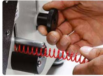
Die APSI 300 compact erfordert für das einfache Setup und die DurchmesserEinstellung kein Werkzeug. Die innovative Durchmesser-einrichtung der APSI erlaubt ein einfaches und präzises Positionieren der Spiralen.
