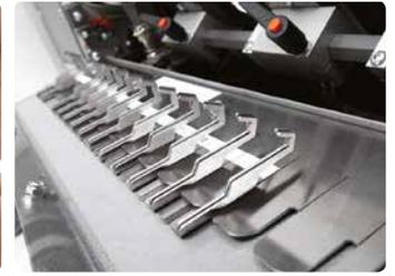
Buchhaltevorrichtungen halten den vorgestanzten Buchblock wenn dieser in der Maschine positioniert wird. Sie stimmen jeweils mit den verwendeten Spiraldurchmessern überein. Die Buchhaltevorrichtungen sind sicher im System aufbewahrt.
