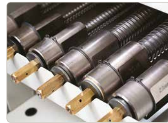
Integrierte Vorrichtung zur Aufbewahrung der Wickeldorne.
